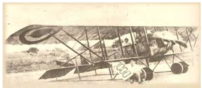
Caudron G – III. Avión pionero de la base aérea de Flandes, fabricado en Francia, diseñado como entrenador militar en 1912, su velocidad máxima es de 70 nudos (aprox. 130 Km/h). Estos aviones carecían de frenos y en aquella época no se habían ideado los trampolines para trancar las ruedas cuando el motor funcionaba y por ello los estudiantes o alumnos debían sostenerlos de las alas.
